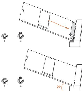
將 M.2 SSD 對準 M.2 插槽並輕輕插入。請注意，M.2 SSD 模組只能朝一個方向安裝。
