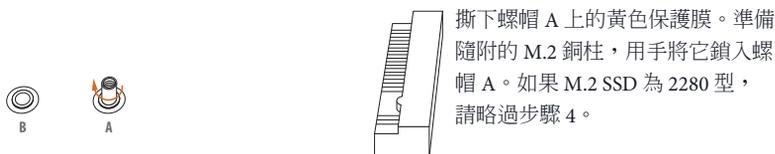
撕下螺帽 A 上的黃色保護膜。準備隨附的 M.2 銅柱，用手將它鎖入螺帽 A。如果 M.2 SSD 為 2280 型，請略過步驟 4。
