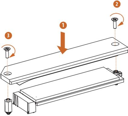
依照所示順序用螺絲起子鎖緊螺絲，固定 M.2 SSD 和 M.2 散熱片。先鎖緊 M.2 接頭對面的螺絲 (2)，再鎖緊 M.2 接頭旁邊的螺絲 (3)。
