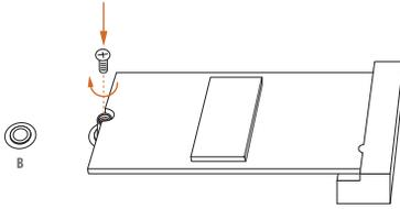
使用螺絲起子鎖緊螺絲，固定模組。請勿過度鎖緊螺絲，以免損壞模組。如果 M.2 SSD 模組為 2280 型，請略過步驟 6。
