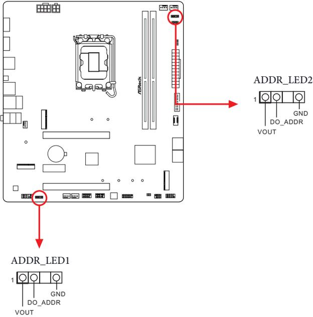
將可定址 RGB LED 燈條連接至主機板上的可定址 LED 排針 (ADDR\_LED1 / ADDR\_LED2)。
